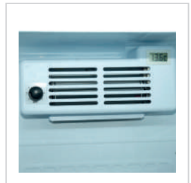
Termostato digital. Ventilador para circulación del aire
